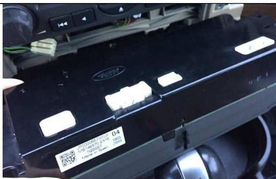
2. Collegare i connettori maschi del cablaggio bypass al pannello di controllo del climatizzatore
