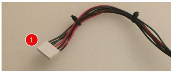
5. Rimontare il pannello di controllo del climatizzatore seguendo a ritroso le procedure effettuate per smontarlo, prestando attenzione a non schiacciare/tagliare i nuovi cablaggi inseriti
